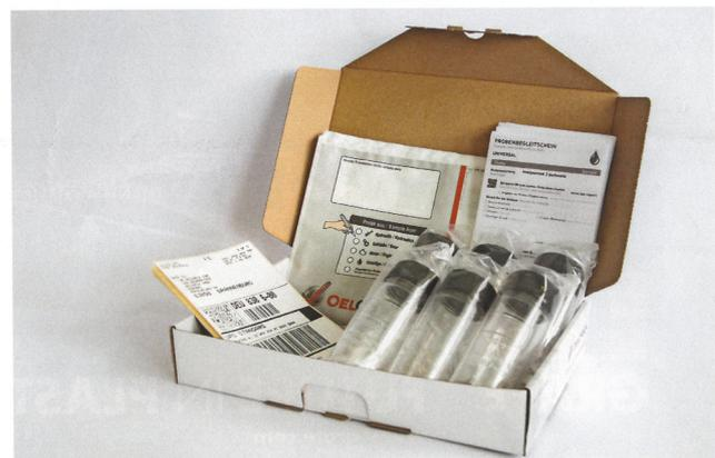
**Oelcheck stellt Analysesets für verschiedene Hydrauliköle zur Verfügung.** Foto: Oelcheck
